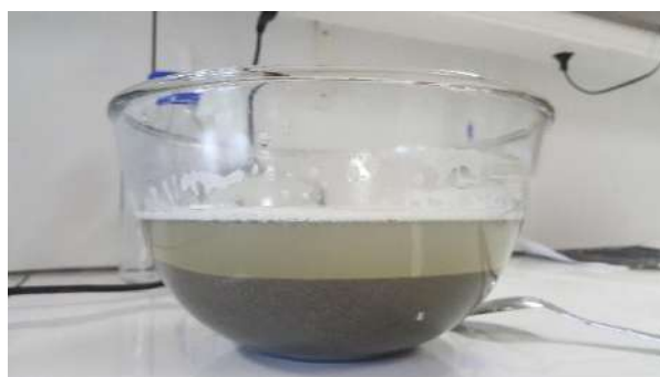
Photo 6 : Mélange du sédiment avec la salure. Le surnageant comprend toutes les particules de faible densité.
