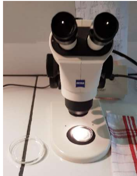
Photo 6 : Les filtres sont observés à la loupe binoculaire, avec un contrôle rempli d'eau à proximité
