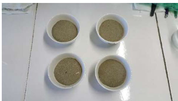
Photo 5 : Les quatre réplikats d'une station après passage à l'étuve
