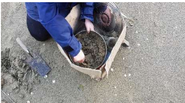
Photo 4 : Homogénéisation des quatre carottes en vue d'un sous-échantillonnage pour former un réplikat
